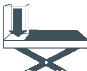
D Eckbelastung verteilt auf 1/2 Plattformlänge 30%
