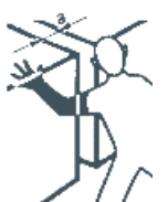
für Arme und geschlossene Hände a = 120 mm
