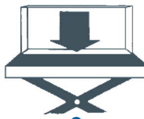
C Einseitige Belastung verteilt auf 1/2 Plattformlänge 30%
