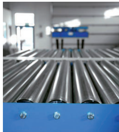
Hubtisch mit Rollenbahn - Einsatz im Versandbereich
